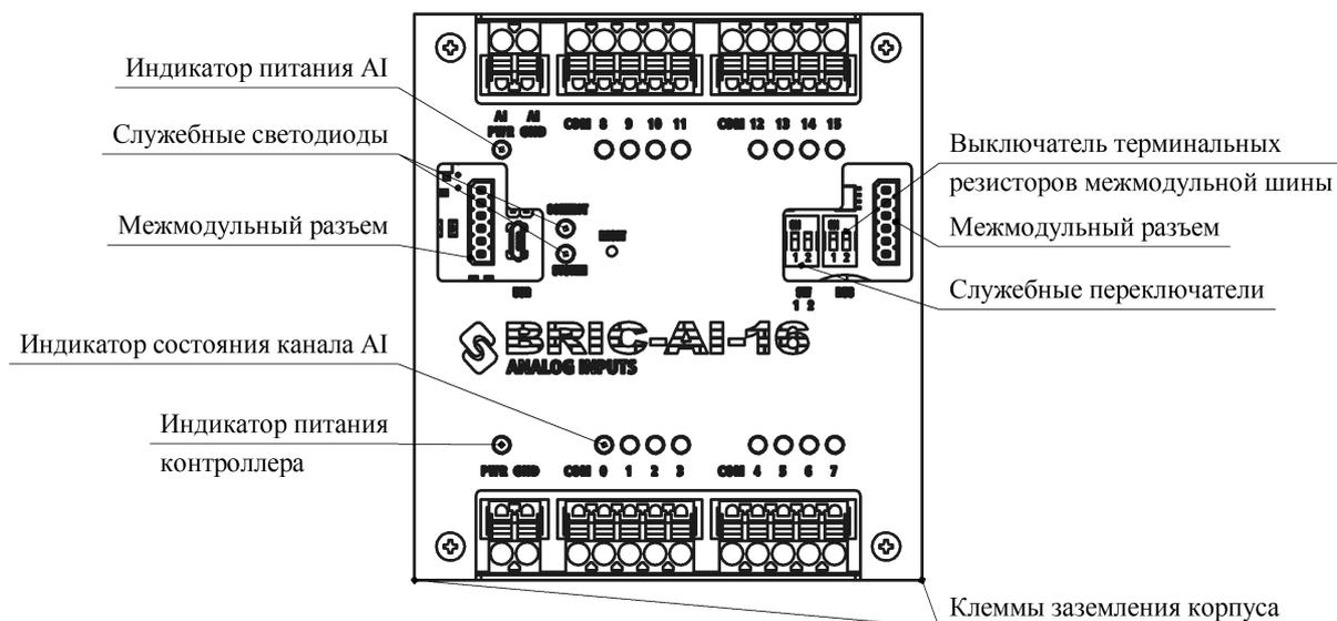
Модуль BRIC-AI-16 выполнен в металлическом корпусе, состоящем из двух частей. Для крепления на DIN-рейку на задней стенке корпуса имеется клипса.
