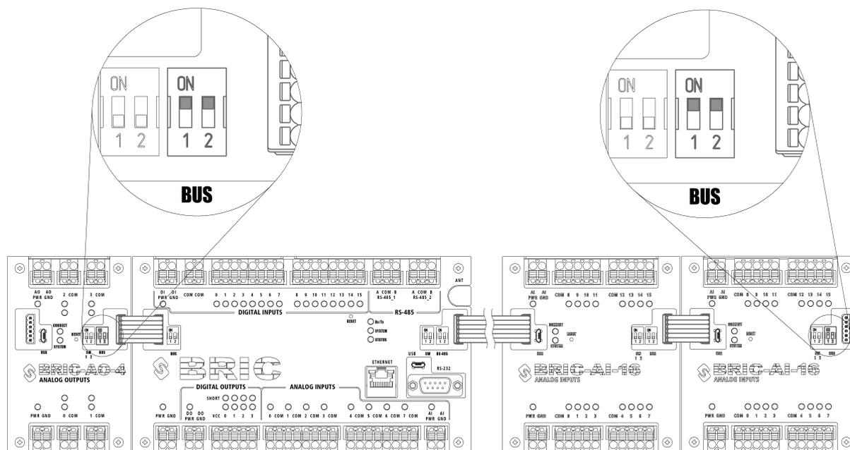
**Примечание:** При протяженности межмодульной шины менее 5м допускается подключение согласующих резисторов (терминаторов) межмодульных интерфейсов только со стороны ПЛК.
