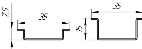
Монтаж модуля на DIN-рейку осуществляется с помощью клипсы, расположенной на задней стенке корпуса.
