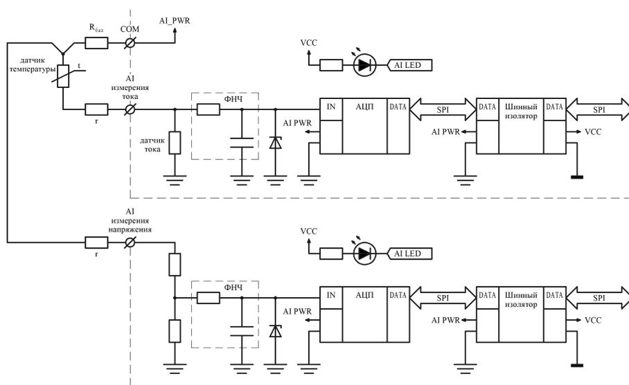
где  $R_{бал}$  - балластное сопротивление 560 - 680 Ом с мощностью рассеивания 0,5 Вт;  $r$  - сопротивление проводов.
